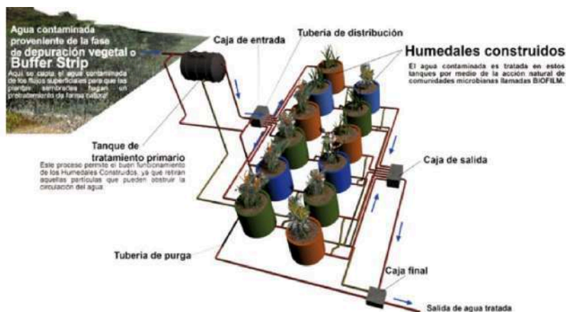
Figura 9. Planta piloto para el tratamiento de lixiviados. Humedal construido de flujo vertical. UNESCOsot, Colombia – TdeA.
