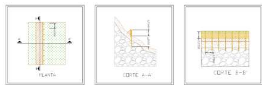
Figura 25. Detalles constructivos de la terraza invertida. Convenio 494 de 2014.
