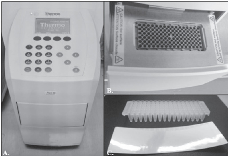
Figura 1. A) Termociclador piko g6 Thermo Scientific, Inc. B) Placa del termociclador g6 Thermo Scientific, Inc. para disponer el plato. C) Plato y lámina adhesiva.
