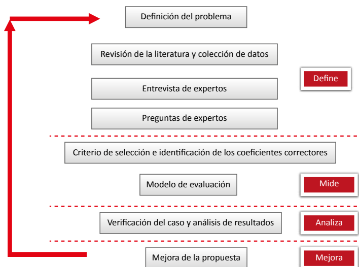
Figura 1. Método del ciclo Six Sigma DMAIC
