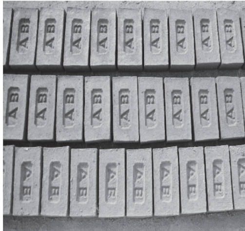
Fig. 11. Ladrillos de arcilla frescos con CCA y bagazo de caña [59].
