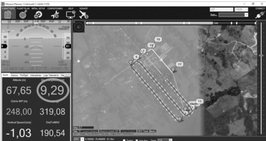
Fig. 13. Desfase del valor de la velocidad entre la programada y el valor instantáneo
